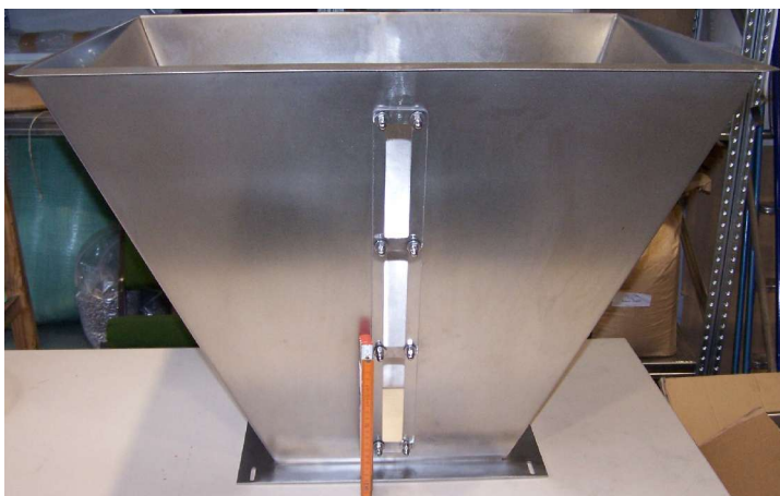
Großer Trichter für den Zulauf Höhe: 62cm (170 l)
